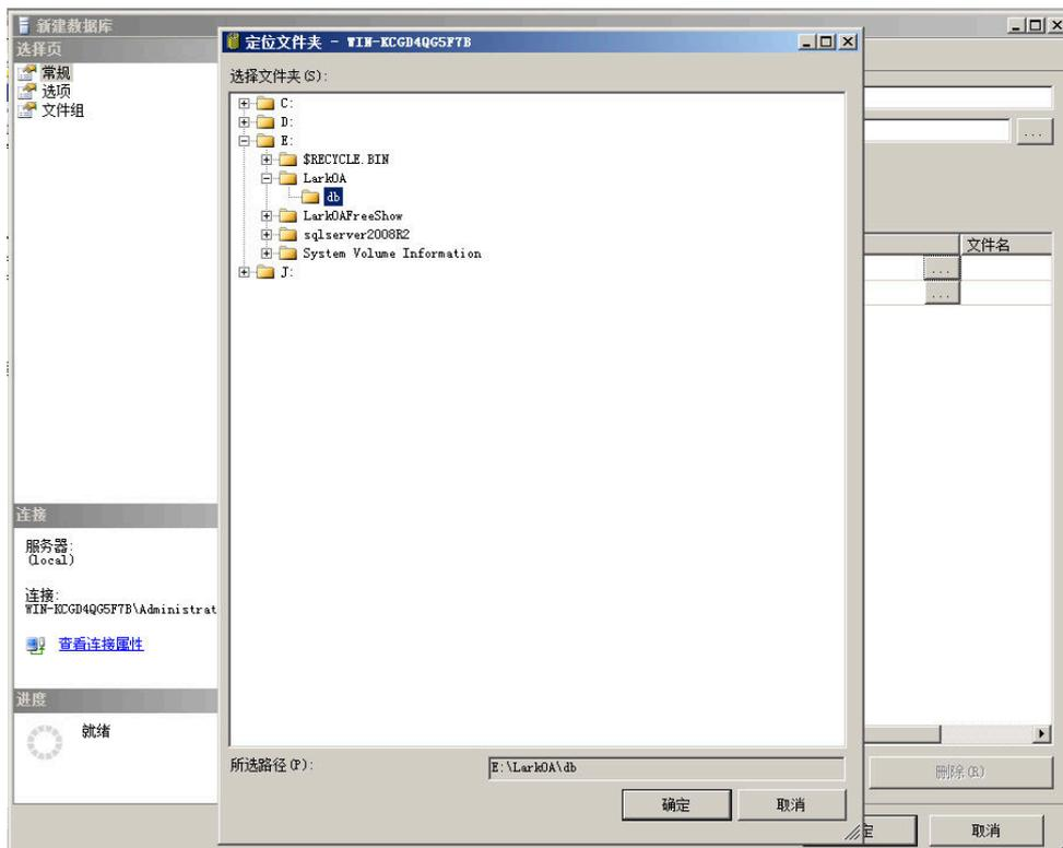
5. 将逻辑名称 LarkOA 和 LarkOA\_log 的路径分别修改后,对话框显示信息如下图所示。点“确定”按钮完成新建数据库的工作。
