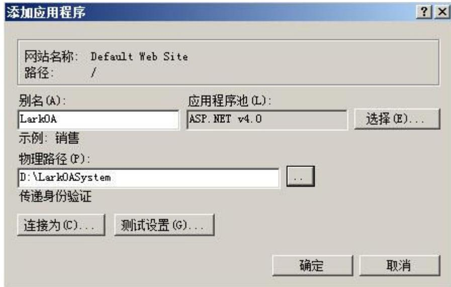
请注意，在进行到这一步时候，请确认您已经在这台计算机上成功安装了 Microsoft .NET Framework 4.0，否则在“应用程序池”，就没有 ASP.NET v4.0 的选项，系统就无法正常运行。
