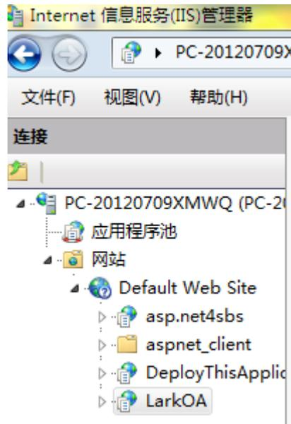
如果您在第一次添加应用程序时未能正确设置应用程序池为 ASP.NET 4.0, 您也可以事后在 IIS 默认网站的“高级设置”里再调整应用程序池的参数。
