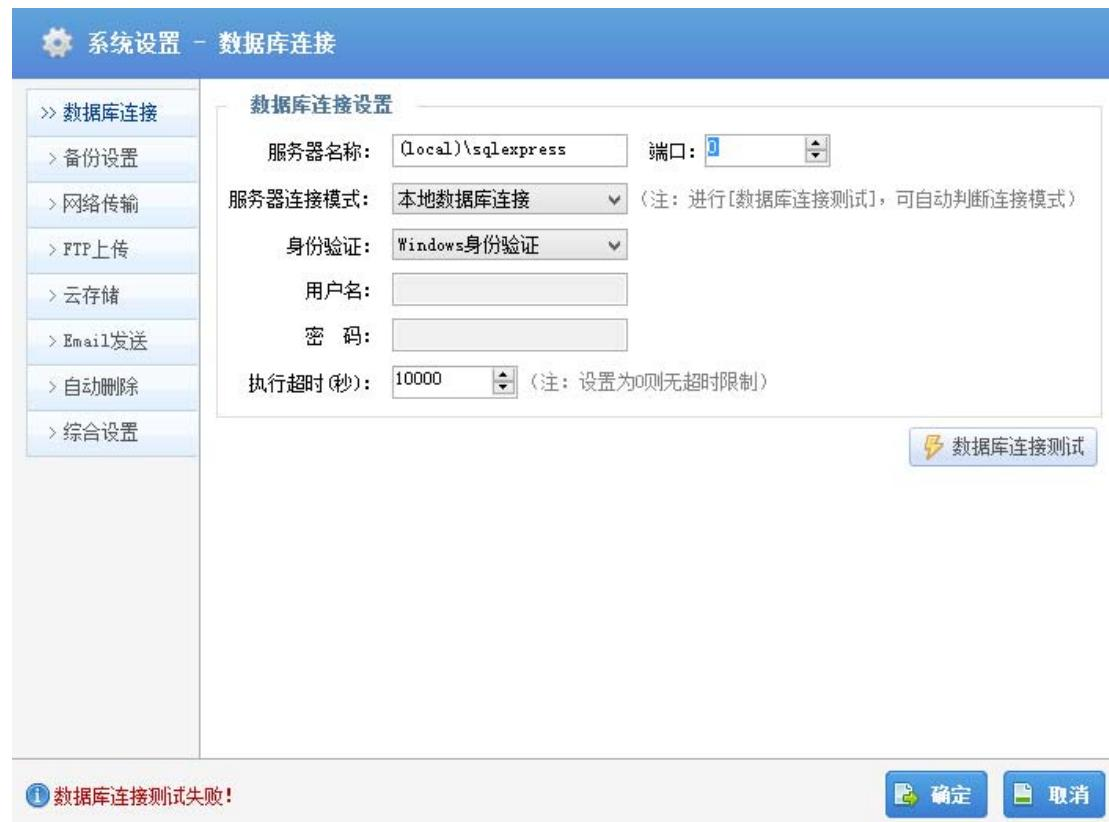
通过“数据库连接”设置，进行目标 SQL 服务器的连接设置。
