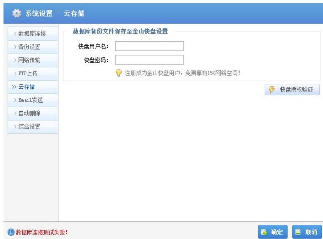
通过“云存储”设置，将本地已经备份完成数据库备份文件，传输到指定的“金山快盘”云存储中。
