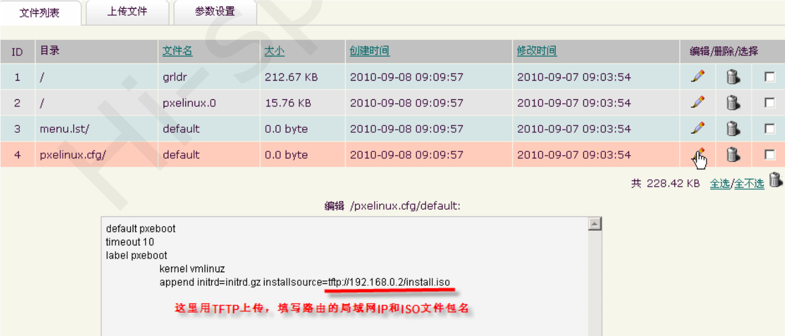
图 3.39. 配置 pxelinux.cfg
