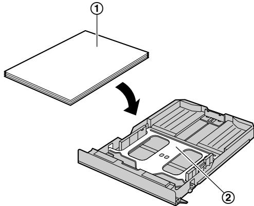
4 调整记录纸引导板。捏住后引导板（①），将其推到纸张尺寸标记处。捏住右引导板（②），将其推到记录纸尺寸的宽度。
